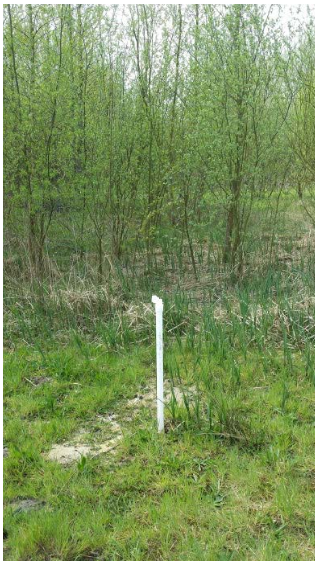
Foto: Monitoringsvoorziening kwetsbaar: peilbuis zonder mantelbuis.
