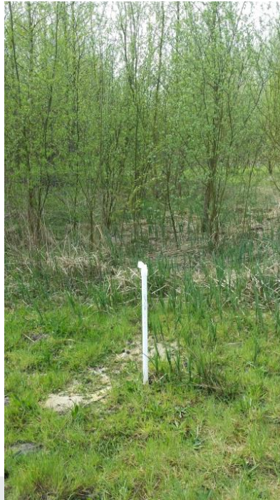
Foto: Monitoringsvoorziening kwetsbaar: peilbuis zonder mantelbuis.
