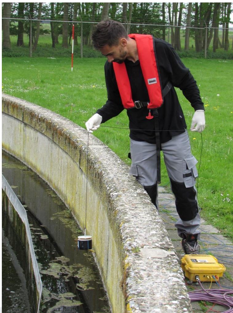
Foto: Aanbrengen meetelektrode.
