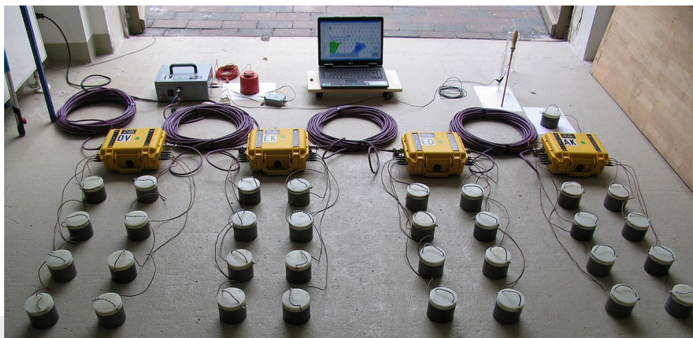
Foto: Voorbeeld van een (semi)permanent meetsysteem.
